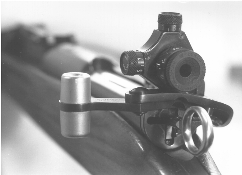
Bild 10: Linksriegel zu Karabiner 31
