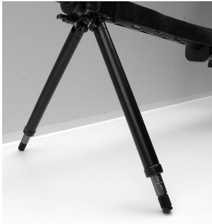
Bild 4: Verstellbare Zweibeinstütze zu Stgw 57 diverse Fabrikate
